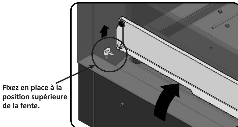
4. Alignez les crochets sur la moulure avec les fentes sur le côté de l'appareil et insérez-les comme illustré en poussant jusqu'à ce qu'elle soit bien alignée avec le devant. Les crochets comportent plusieurs fentes (1/4" [6 mm] de distance) pour s'adapter à différents matériaux de finition.
