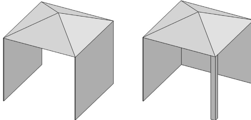
Installation à l'intérieur d'une enceinte partielle qui comprend un recouvrement sur le dessus et trois murs latéraux, dans la mesure où 30 pour cent ou plus de la périphérie horizontale de l'enceinte est ouverte en permanence.
