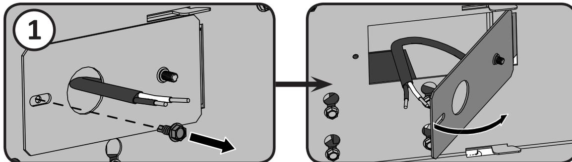
Insérez le connecteur de boîte à travers le trou de 7/8" (22,2 mm) puis dans la plaque de jonction.
